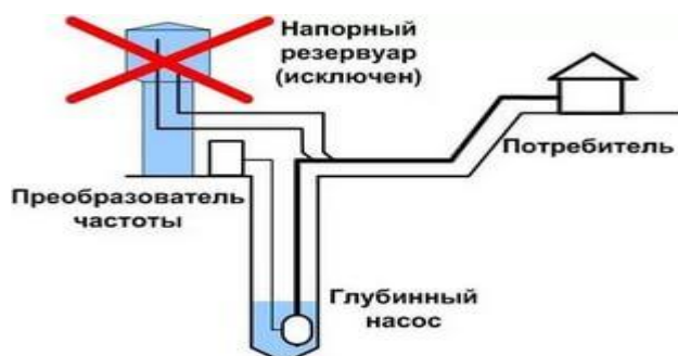
Рисунок № 1.2. Изображение глубинного насоса
